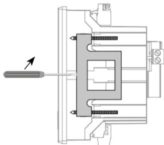
Die Befestigung erfolgt anschließend über das Einschieben und Einrasten der Klammern mit anschließendem Eindrehen der Schrauben.
