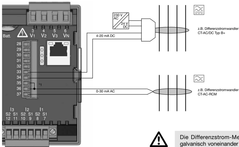
Anschlussbeispiel zur Messung von Differenzströmen vom Typ B und A. (Netzteil mit U = 24V DC, Restwelligkeit < 5%, Leistung: 24W)
