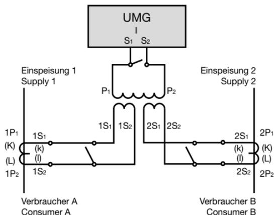
Abb. Strommessung über einen Summenstromwandler (Beispiel).
