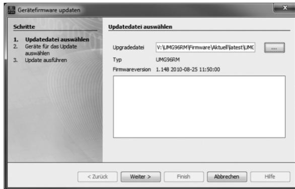
Abb. Firmwareupdate-Assistent der Software GridVis
