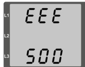
Abb. Warnmeldung mit Nummer 500 (Netzfrequenz)
