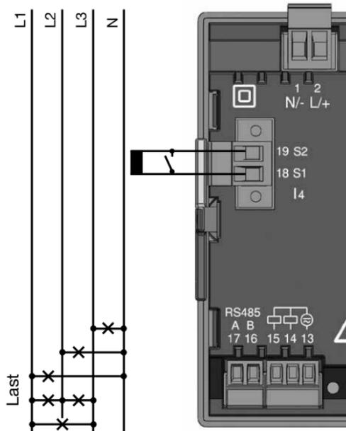
Abb. Strommessung (I4) über Stromwandler (Anschlussbeispiel)
