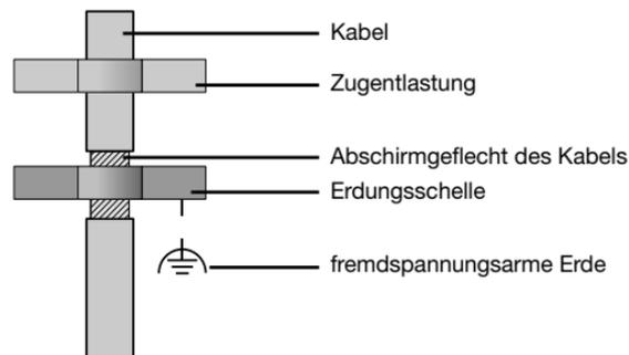
Abb. Abschirmungsauslegung bei Schrankeintritt.
