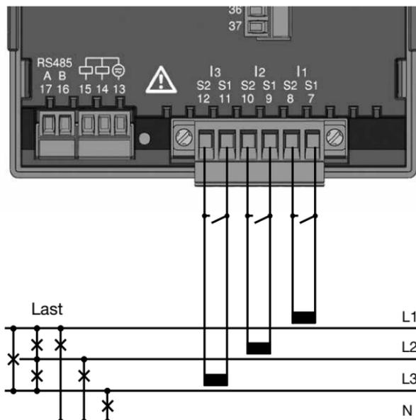
Abb. Strommessung (I1-I3) über Stromwandler (Anschlussbeispiel)
