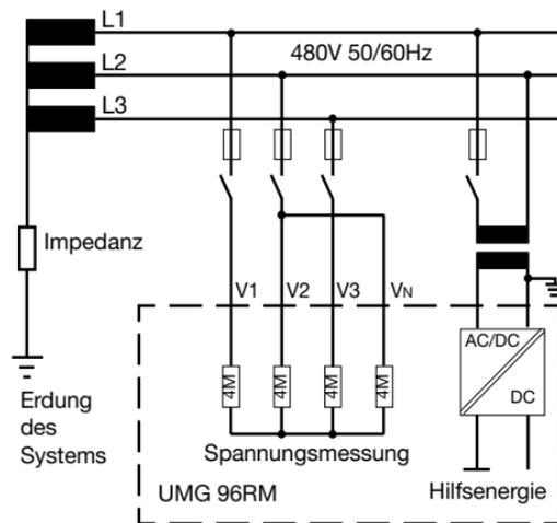
Abb. Prinzipschaltbild - Messung in Dreiphasen-3-Leitersystemen.
