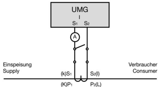
Abb. Strommessung mit einem zusätzlichen Amperemeter (Beispiel).
