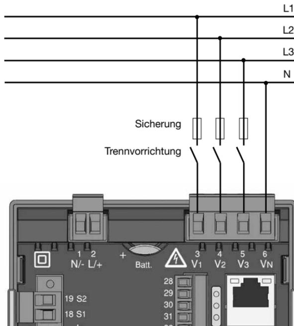
Abb. Anschlussbeispiel für die Spannungsmessung
