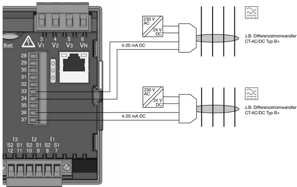
Anschlussbeispiel zur Messung von Differenzströmen vom Typ B. Jeder Differenzstromwandler der Baureihe *CT-AC/DC Typ B+ RCM* benötigt ein eigenes Netzteil (mit  $U = 24V$  DC, Restwelligkeit  $< 5\%$ , Leistung: 24W). **Die Sekundärseiten der Netzteile (24V DC) müssen galvanisch voneinander getrennt sein!**
