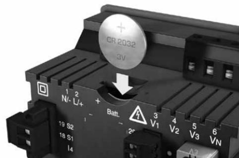
Abb. Batterieeinschub auf der Rückseite
