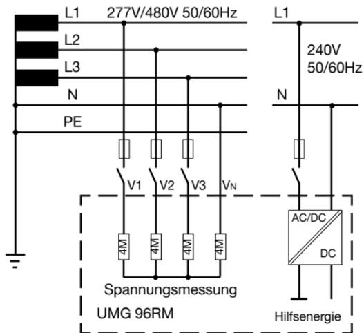
Abb. Prinzipschaltbild - Messung in Dreiphasen-4-Leitersystemen.
