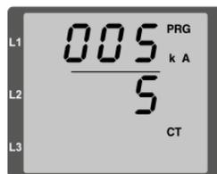
*Abb. Programmier-Modus Stromwandler*
